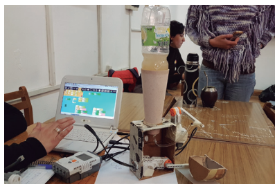
Sistema que cambia el agua para el perro. Vuelca la vieja y agrega nueva.
